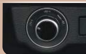
Núm gạt cầu với ba chế độ, thời gian gạt cầu nhanh chỉ trong 0.64 giây, giúp xe vận hành linh hoạt hơn trên nhiều loại mặt đường.
