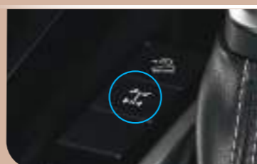
Khóa vi sai cầu sau cho phép phân bố lực kéo đều cho hai bánh xe sau, giúp xe dễ dàng vượt qua địa hình phức tạp.
