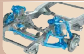
Hệ thống treo trước độc lập, tay đòn kép giúp xe êm ái và ổn định.
